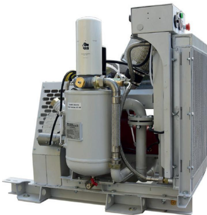
АКВ 5,25/1 П У2 устанавливаются и эксплуатируются на тепловозах ТЭМ9, ТЭМ9ТА, ТЭМ7А и ТЭМ14 производства ОАО «Людиновский тепловозостроительный завод». АКВ 5,25/1 П У2 может изготавливаться сукороченной рамой и кронштейном под гидромотор для тепловозов ТГ16М.
