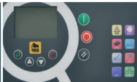
Блок управления компрессором Airmaster Q1
